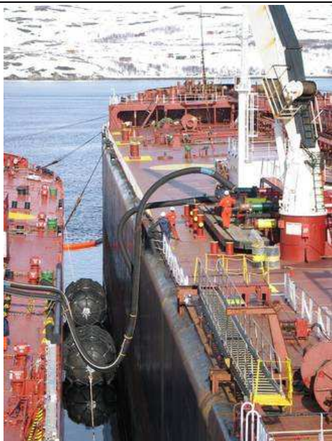
Lasteslanger koblet mellom skipene
