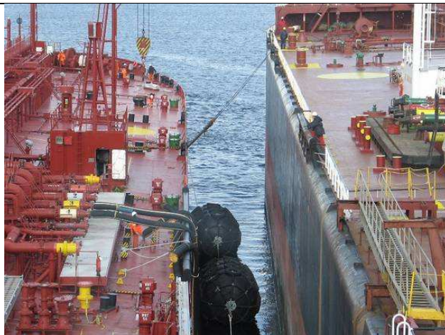
Lasteslanger montert og ferdige for kobling til Songa Anette
