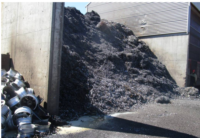
Bilde 1: Pøl med melkelignende væske (typisk kjølevæske) renner fra mellomlagret jernspen. Når bildet ble tatt, torsdag 9. juni, hadde det ikke regnet siden fredag 3. juni (og da kun 3 mm). 2
