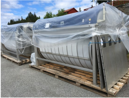
Bilete 4: Filter klar til å monterast i nytt reinseanlegg på eksisterande avløp.
