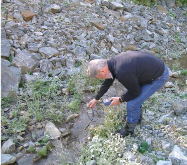
Bilde 9 prøvetaking ledningsevne ved utløp drenasjevann, se også vedlegg 1
