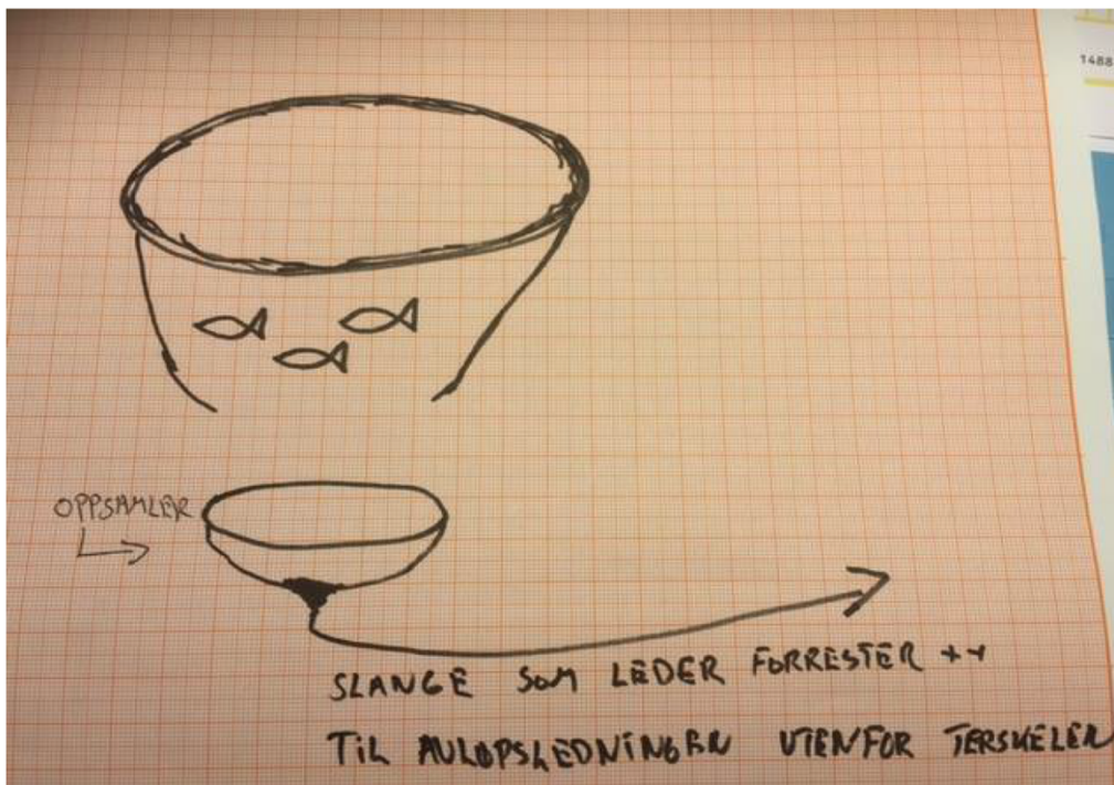
Figur 2. Skisse av system («up-lift») som skal lede partikulært utslipp fra merdene på lokalitet Lilleelv til en utslippsledning og forbi terskel. Bilde hentet fra kommunikasjon med søker.
