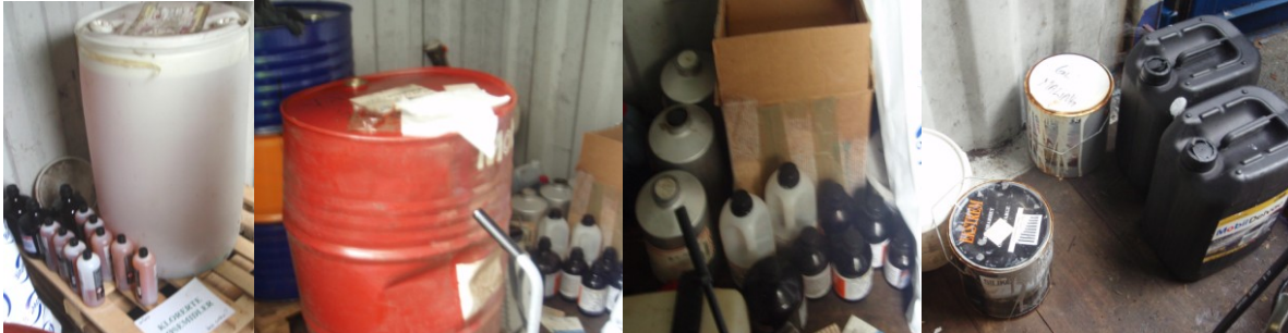
Bilder fra container for mellomlagring av farlig avfall. Emballasjen er mangelfullt eller ikke merket.
