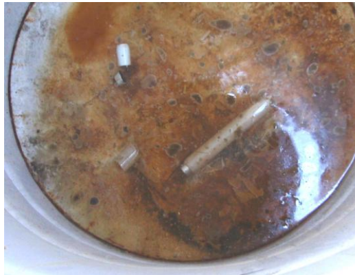
Bilde 2: Knust lysstoffrør medfører kvikksølvtutslipp.
