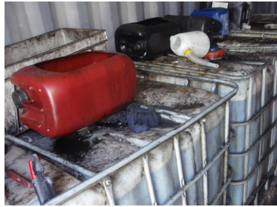
Bilde 3: Spillolje. Merk oljesøl utenpå IBC-ene.
