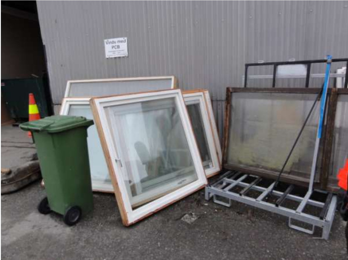
Isolerglassvinduer oppbevart på bakken utenfor hallen for oppbevaring av farlig avfall.
