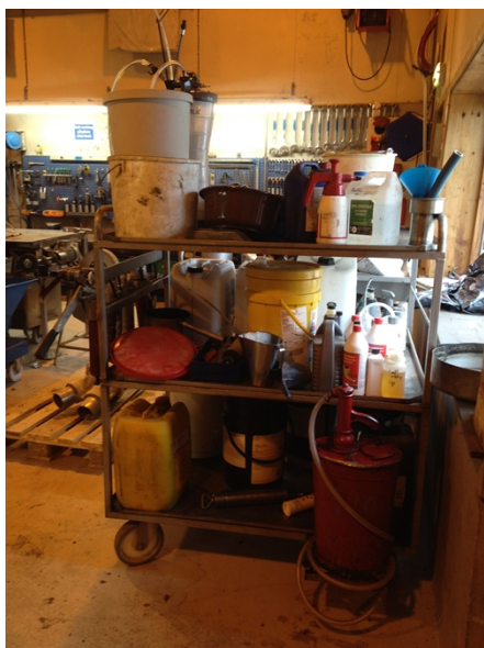
Bilde 1. Lagring av kjemikalier uten barriere for utslipp til ytre miljø (foto: Fylkesmannen i Nord-Trøndelag).
