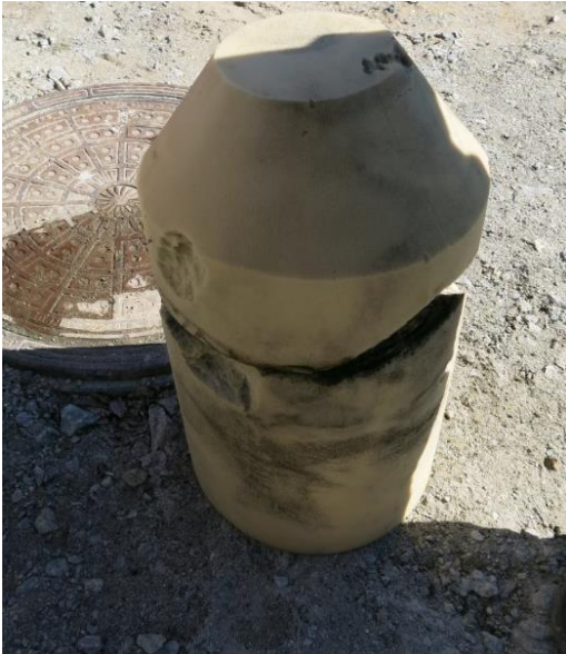
Bilde 1 - Propp av skumgummi for å rense belegg på utslippsledning
