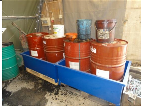
Fat for farlig avfall med mangelfull merking
