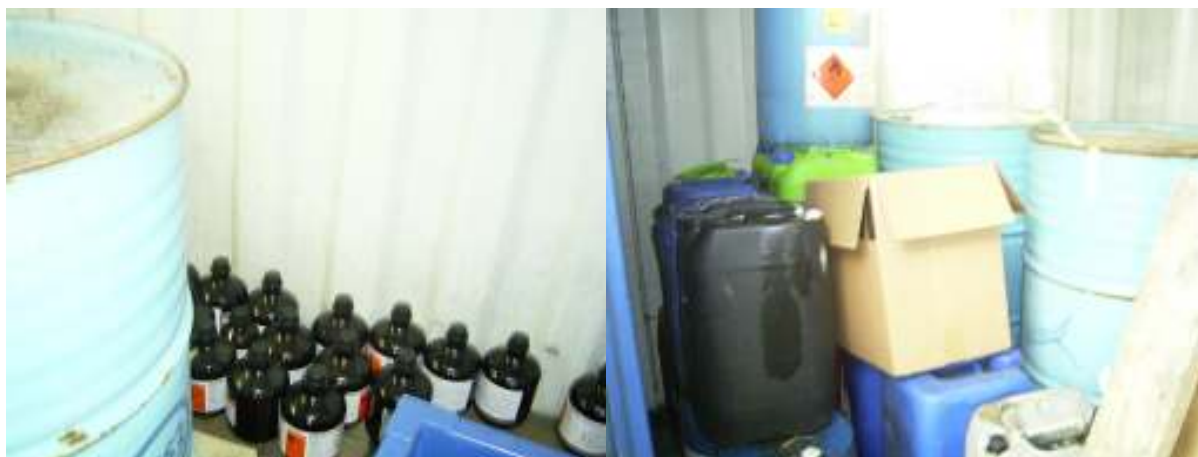
Bilde nr.2 (a og b): Manglende/mangelfull merking av farlig avfall. Containeren var dessuten svært full
