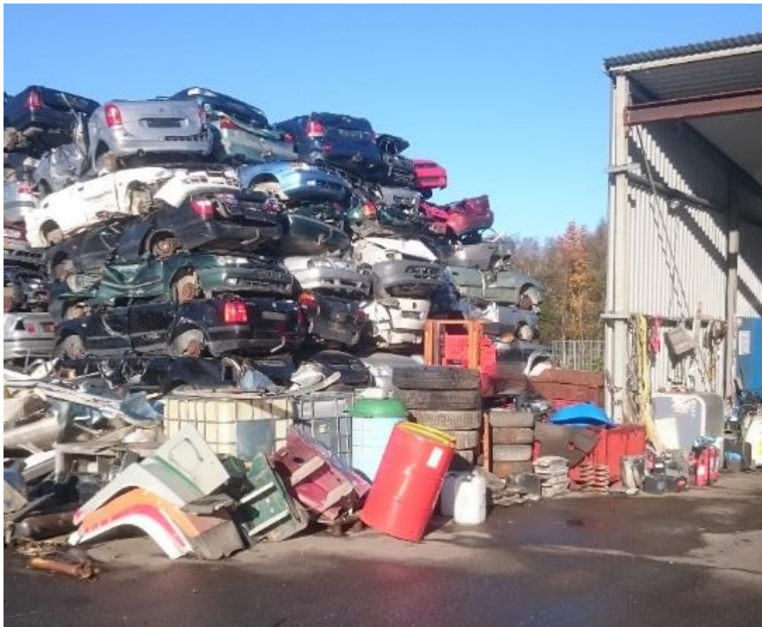
Miljøsanerte biler lagres inntil 8 i høyden på tett dekke i påvente av at pressebilen kommer Foto tatt 19.10.2017 av FMNT.
