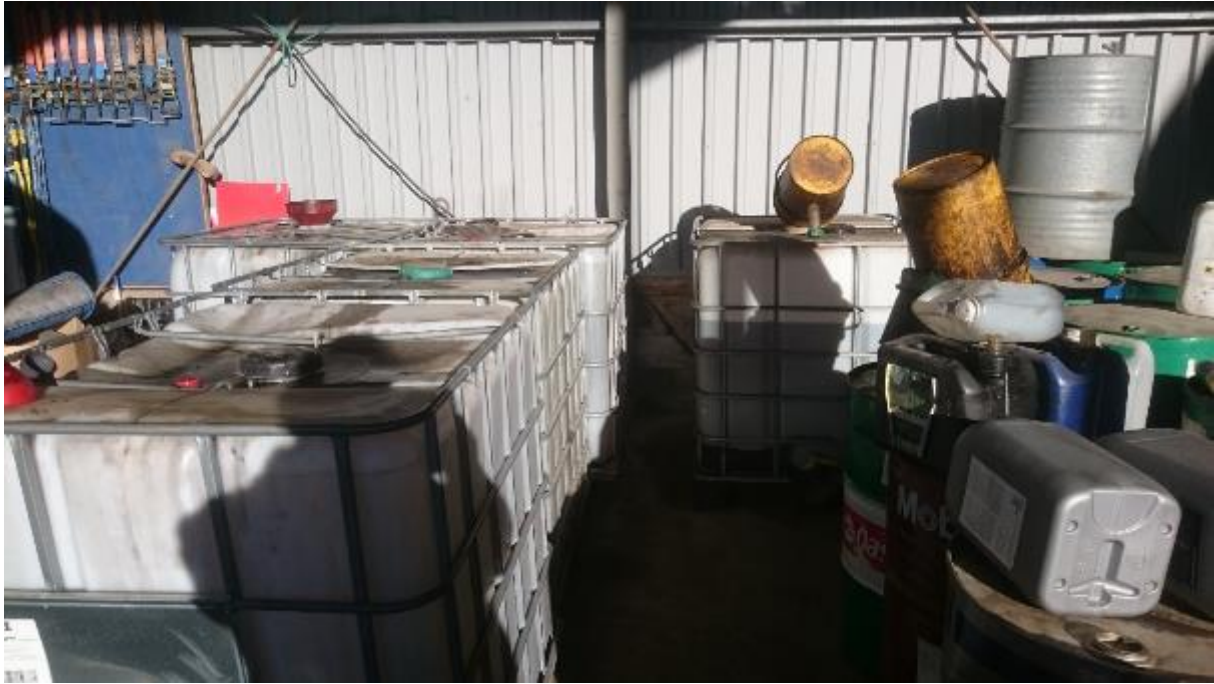
Lagerplass for farlig avfall. Farlig avfall var 19.10.2017 utilstrekkelig merket og lagringsplassen rotete/overfylt. Foto: FMNT
