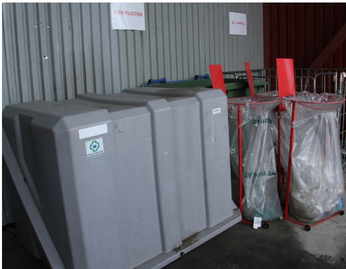
Bilde 1 og 2: Mangelfull merking av batteribeholder og lagring av batteri (Foto: Fylkesmannen i Nord-Trøndelag)
