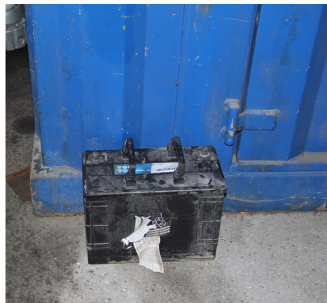
Bilde 1 og 2: Mangelfull merking av batteribeholder og lagring av batteri (Foto: Fylkesmannen i Nord-Trøndelag)
