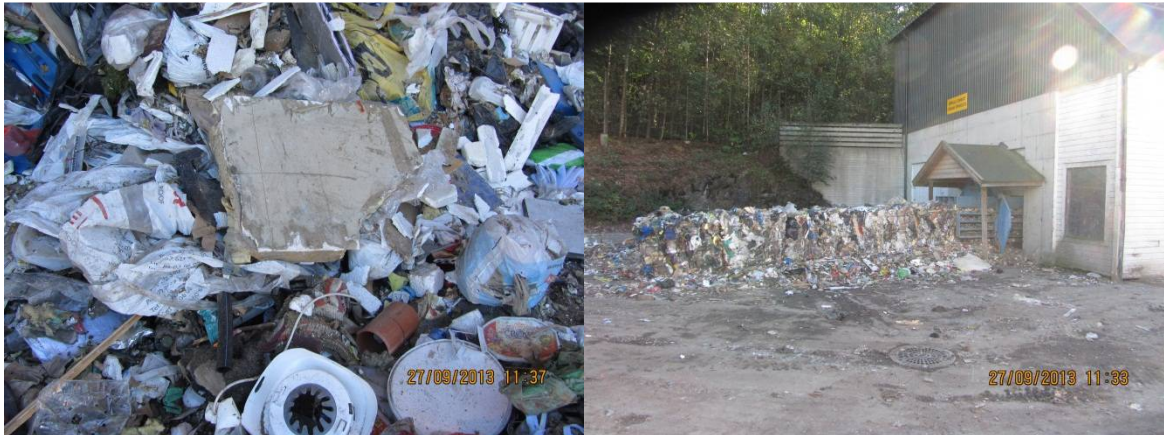
Bilde 1 venstre: Sandwich-element med PUR-isolasjon blir blandet med restavfall og ligger klar for pressing.
