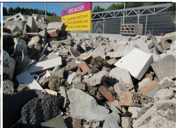
Betong og asfalt var blandet inn i de rene massene (Foto: Fylkesmannen i Oslo og Akershus)
