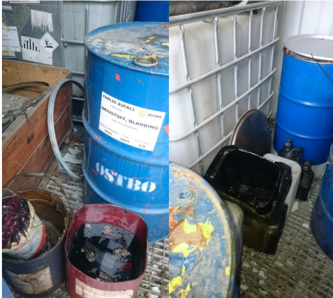
Bilde: Farlig avfall som er satt inn i lagringscontaineren uten tilfredsstillende emballering eller merking.
