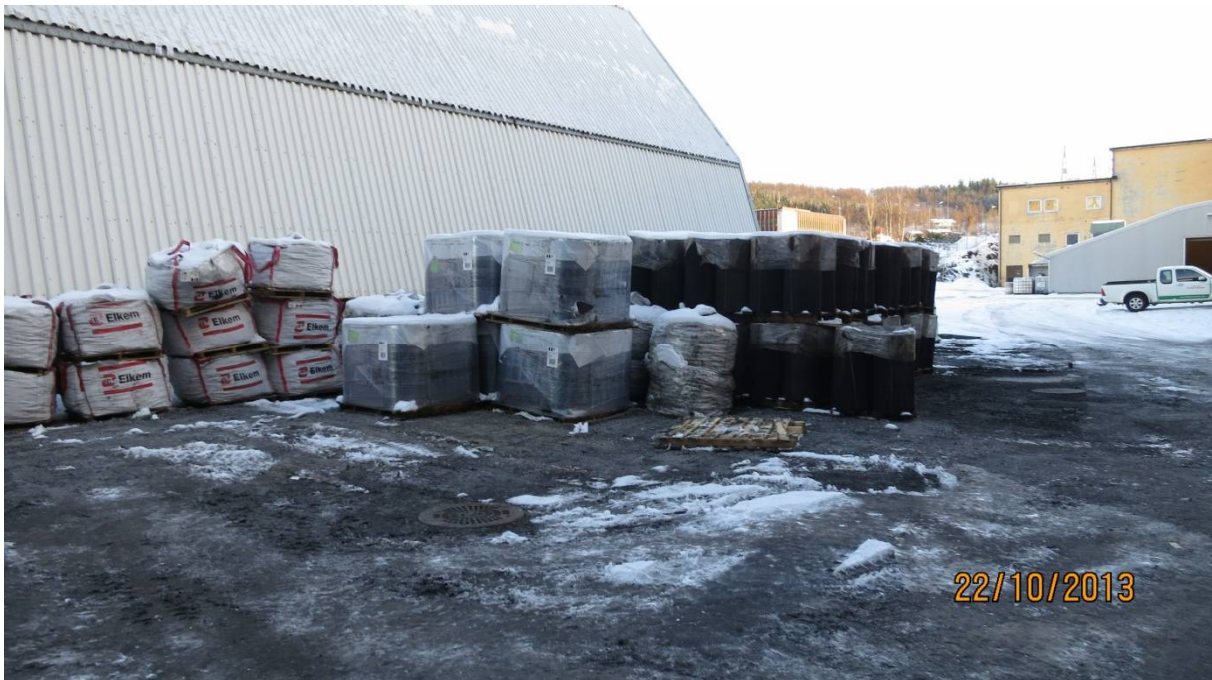
Utendørslagring av elektroder. Vannprøve tatt i kum i nederste del av bildet.
