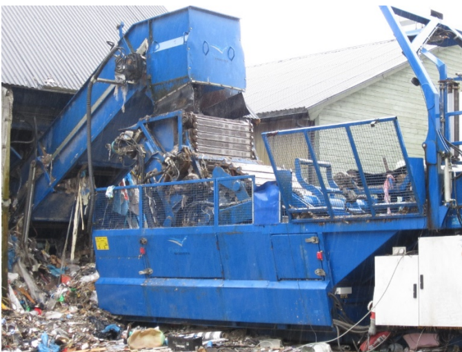
Bilde 18: Pressing avfall utandørs og på grusdekke
