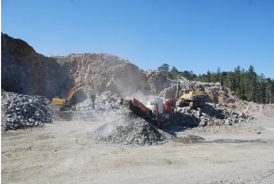
Bilde 3 – pukkverk kan føre til vesentlige støv- og støyplager. Knuseverket på Doneheia ligger ca. 350 meter til nærmeste nabo, men er anlagt slik i terrenget at støv- og støyplager blir redusert.
