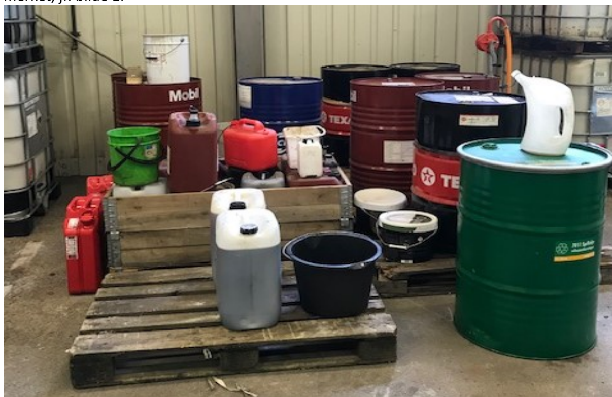
Bilde 1: Kjemikalier og farlig avfall lagres sammen og uten tydelig merking.
