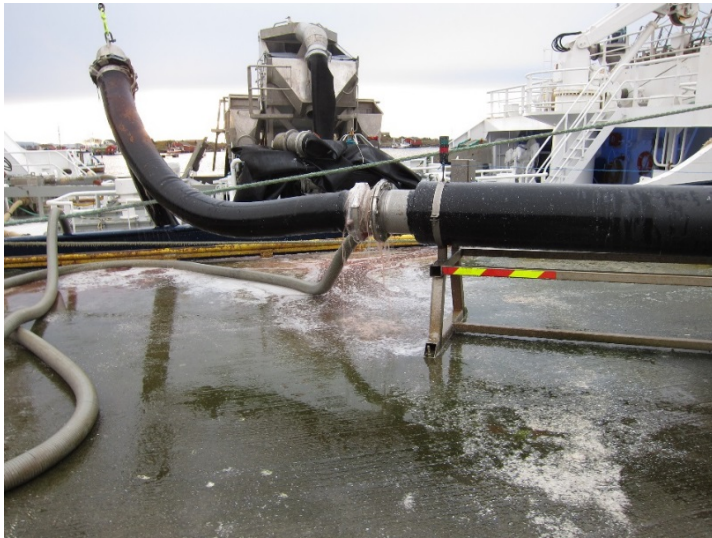
Bilde nr. 1: Lekkasje på slange og kobling under lossing av sild
