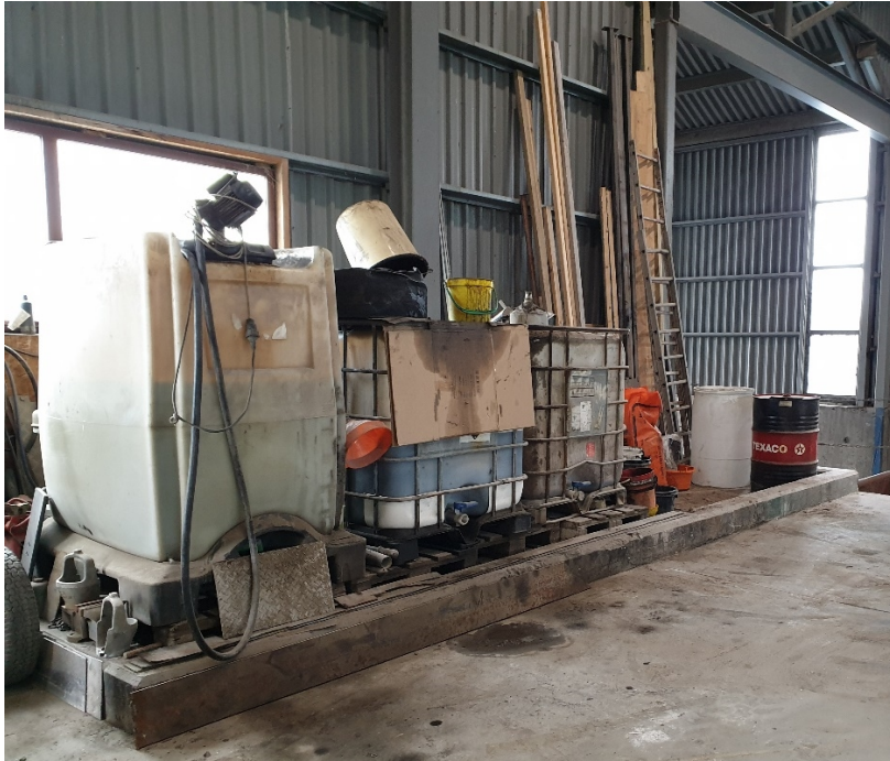
Bilde 1: Farlig avfall oppbevart uten tilstrekkelig merking
