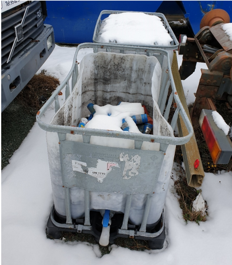
Bilde 2: Farlig avfall oppbevart uten tilstrekkelig sikring mot forurensning
