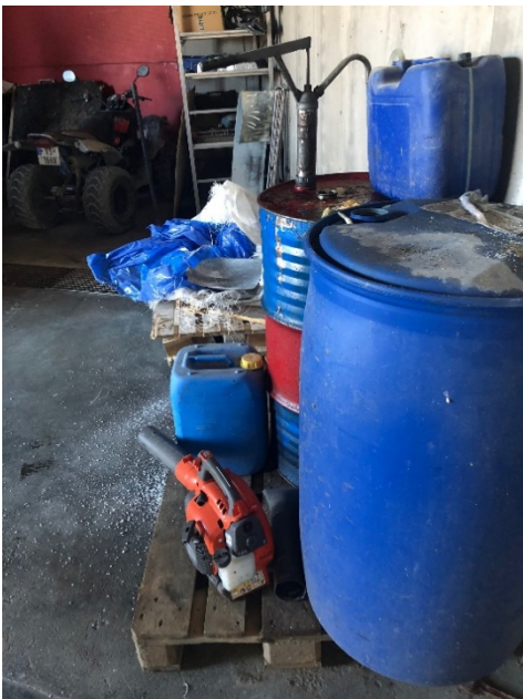
Bilde 2. Lagring av kjemikalier ved sluk.
