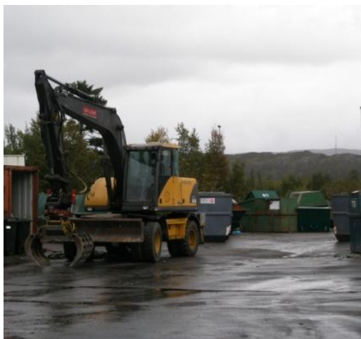
Foto: Maskin med klograbb for sortering av avfall.
