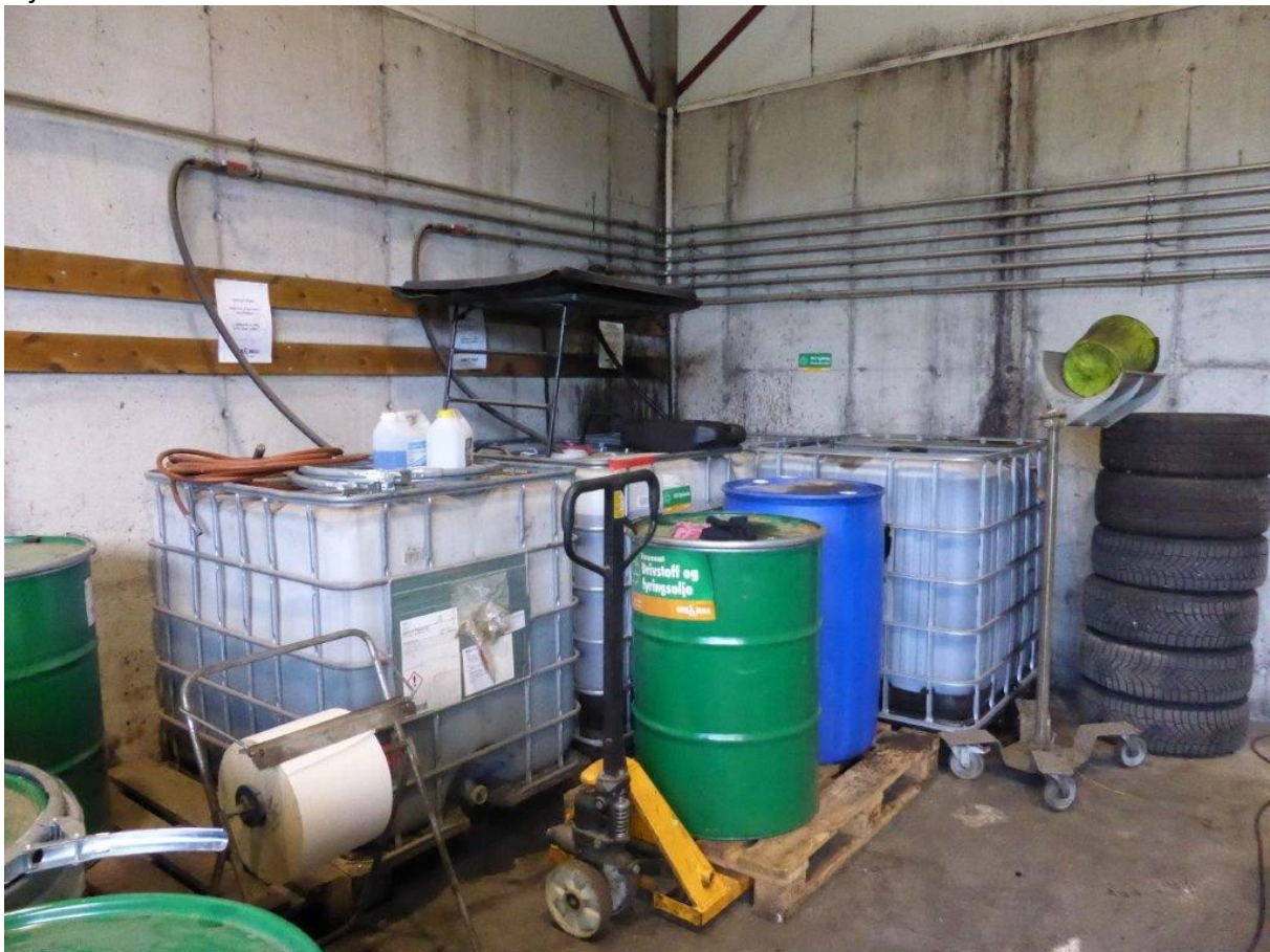
Foto 2. Lagring av væsker i miljøsaneringshall uten oppsamlingssikring.
