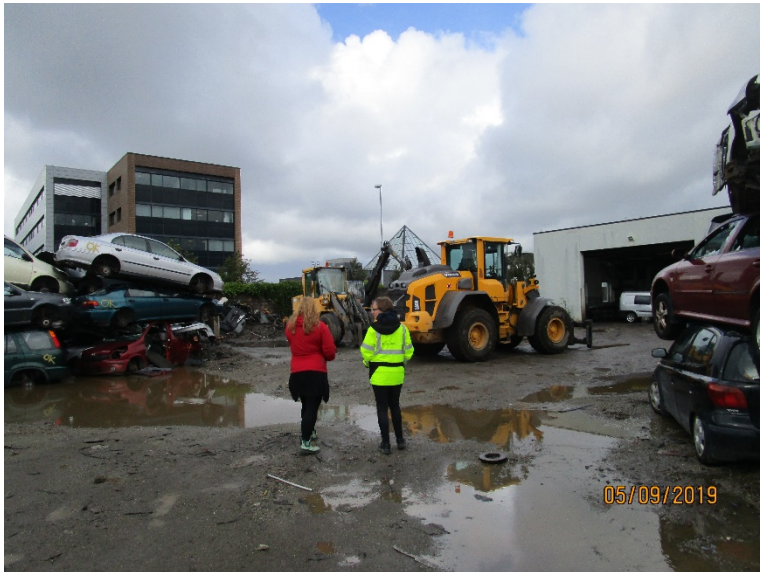
Bilde 1: Vann som blir stående på tett dekke
