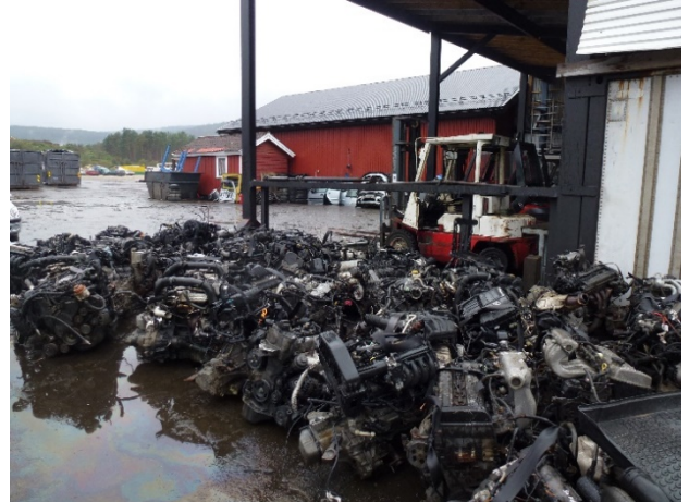
Bilde 2: Viser lagring av motorer i kanten av betongdekke. Vannet, som også renner bak bygget, har tydelig oljefilm.
