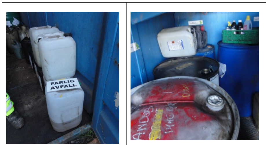
Mangelfull merking av farlig avfall. Foto: Fylkesmannen i Oslo og Akershus
