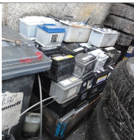
Batterier ikke beskyttet mot nedbør
