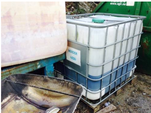
Bilde 1. Oppbevaring av spillolje med ukorrekt merking og uten oppsamlingsmuligheter ved søl/lekkasje.
