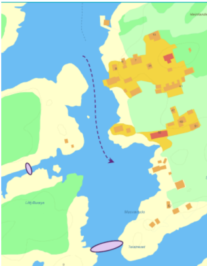
Figur 1: Givær havn. Sirklene viser stedene hvor det skal fylles ut. Stiplet linje viser farled hvor det skal mudres. Kartet er hentet fra søknaden.
