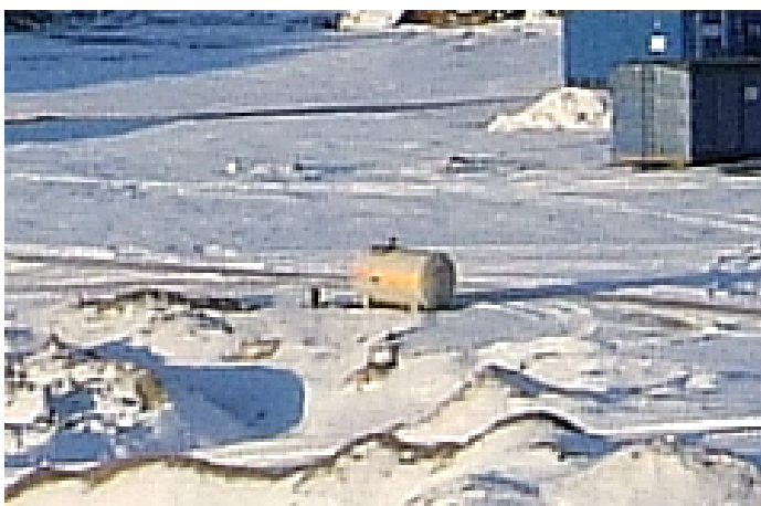
Bilde 3: Dieseltank til maskinpark bør lagres på fast dekke for å unngå forurensning ved uhell.
