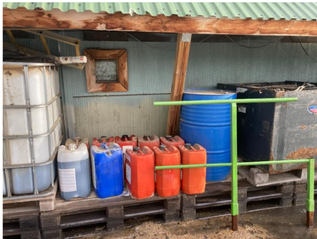
Figur 2: Bildet til venstre viser utendørs-lager under tak, men uten oppsamlingsarrangement. Bildet til høyre viser lagring innendørs, det var uklart hvor mye av dette som var farlig avfall. Avfall på begge lagringsplassene manglet god merking.
