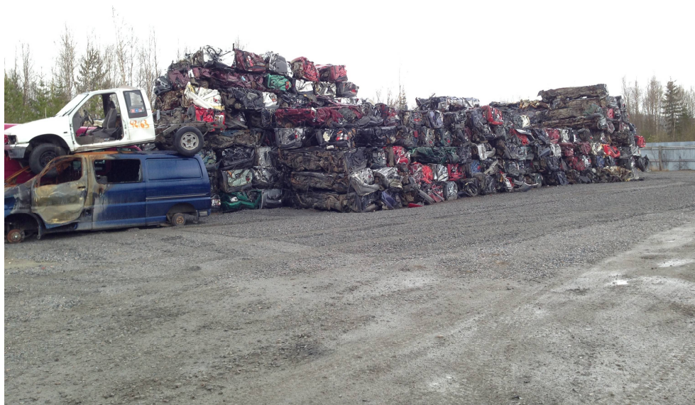
Lagring av pressede biler uten fast ugjennomtrengelig dekke tilknyttet oljeavskiller. Foto tatt 11.5.2015 av Fylkesmannen i Nord-Trøndelag.
