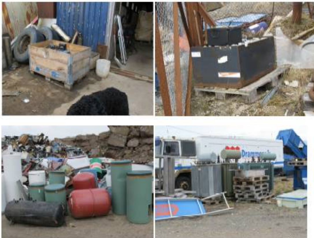
Bilde 4. Bilbatterier lagres i kasser utendørs uten skjerming for vær og vind og annen ytre påkjenning. EE-avfall mottas for metallgjenvinning, tillatelsen åpner kun for mottak og behandling av skrapmetall.
