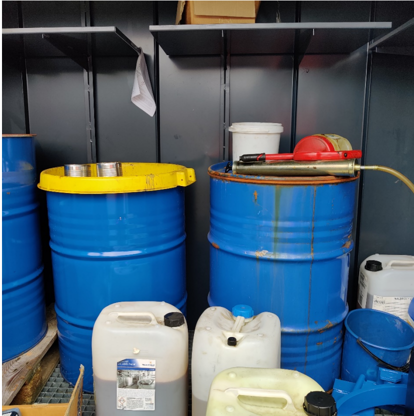
Bilde 1. To fat med farlig avfall som ikke er merket med avfalllets innhold.
