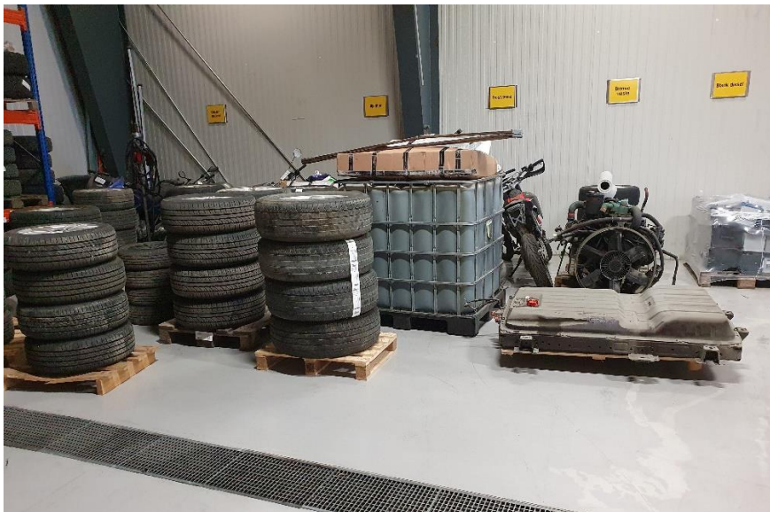
Bilde 1 Innendørs lagring av farlig avfall med feil/ingen merking (Foto: Ida Frøya Svendsen v/Statsforvalteren i Trøndelag)
