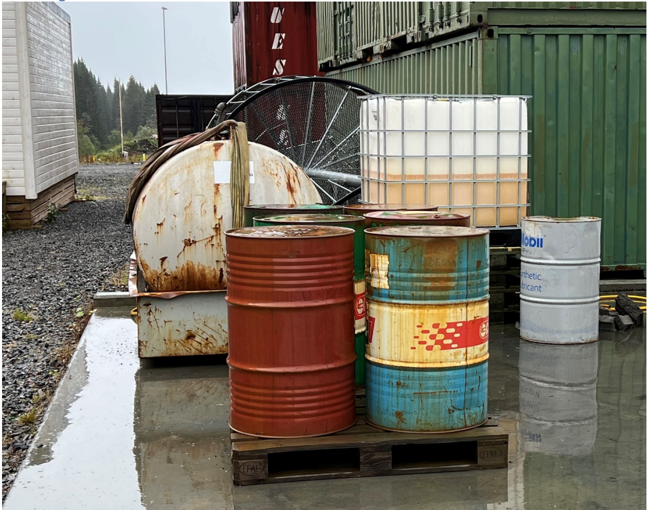
Oppbevaring av kjemikalier på «droppplate».
