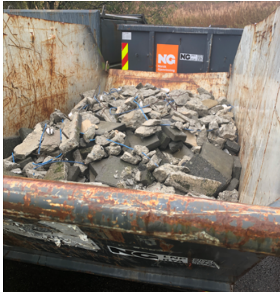
Bilde 2: Betongavfall i utendørs kontainer.
