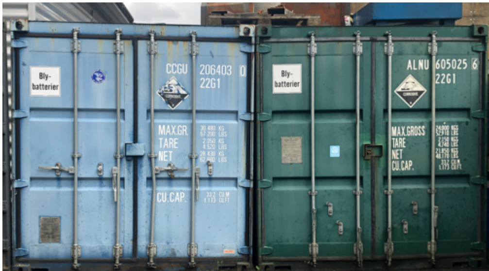
Figur 4: To kontainere merket som blybatterier (begge uten avfallsstoffnummer og EAL-kode). Den grønne kontaineren til høyre inneholdt gasser i trykkbeholdere.
