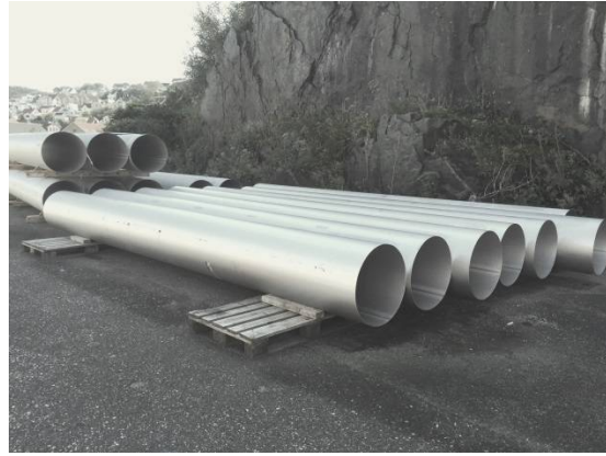
Bilde 2: Rør til oppgradering av luktrensianlegg.
