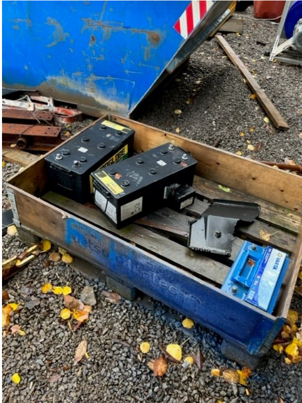
Bilde 2: Lagring av blybatterier
