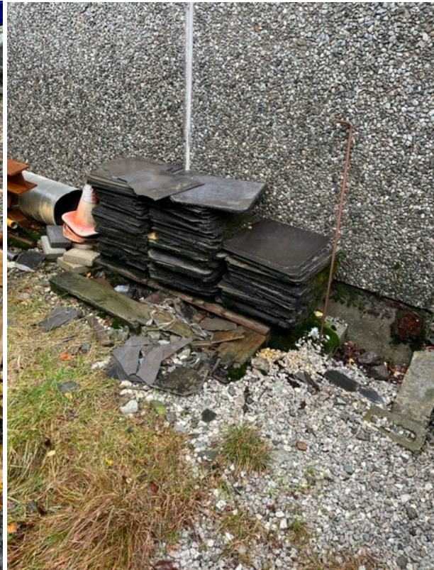
Bilde 3: Lagring av eternittplater
