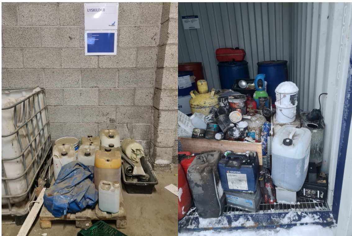
Figur 1: Avfallsstasjonen til venstre viser manglende samsvar mellom merking og hva som lagres. Innholdet i kannene var uklart, men Miljødirektoratet fikk oppgitt at det sannsynligvis var farlig avfall. Oversiktsbildet til høyre viser organisering av avfallet i kontainer for farlig avfall, hvor ulike typer farlig avfall er sammenblandet.
