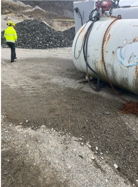
Bilde 1: Diesel på bakken ved siden av tanken
