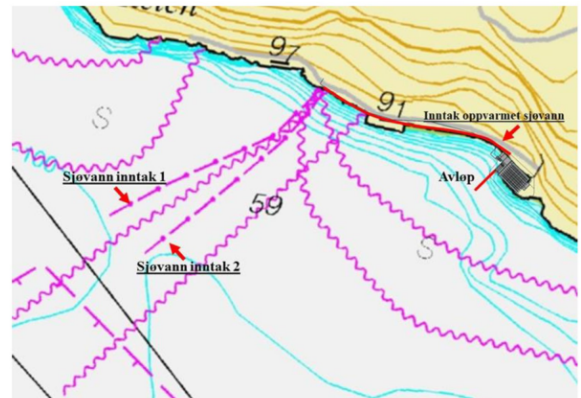
Figur 1 - Oversikt over vanninntakene til Green Mountain og viderekobling av det oppvarmede sjøvannet til hummeranlegget på Ormaneset.
