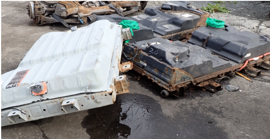
Mellomlagring av elbil-batterier ute. Foto: Statsforvalteren i Oslo og Viken
