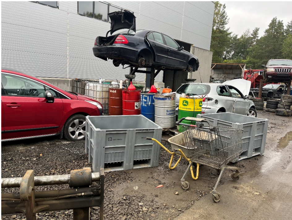
Bilde 1 Lagring av farlig avfall utendørs. Bildet viser også at saneringen foregår utendørs, jf. avvik 2.
