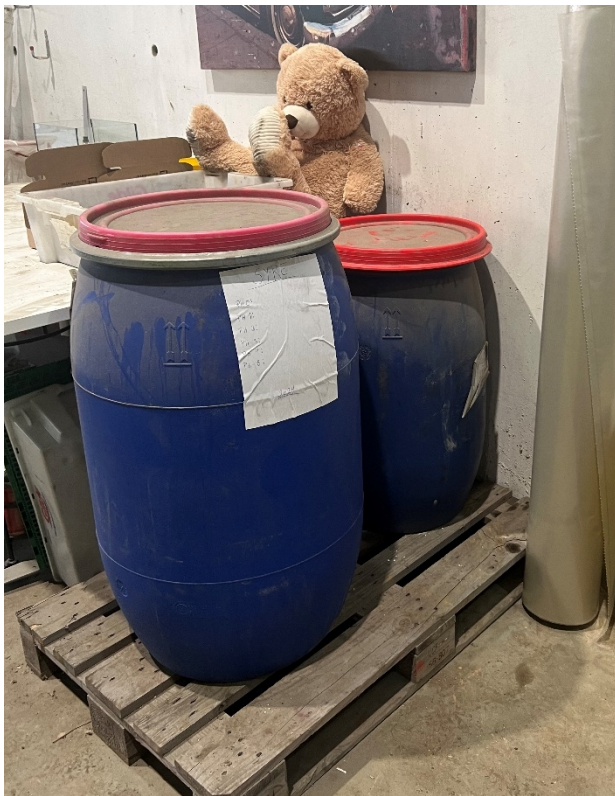
Figur 2: Viser lagring av syre og base i hall 6 som var lagret helt inntil hverandre.
